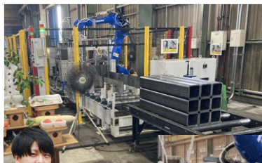
試運転中の溶接ビード研削ロボット「アイリス」
